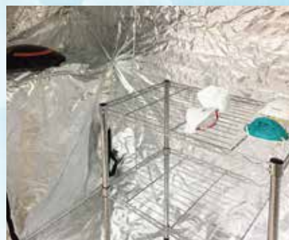
医療資源不足への対応：紫外線照射によるN95マスクの消毒・再使用（左の黒い部分から紫外線を照射）
